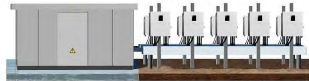
Exemples d'onduleurs installés à l'extérieur et transformateur dans un poste béton
